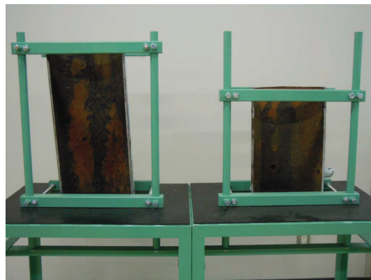
女川 1 号炉 復水浄化系配管の減肉
