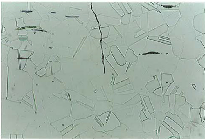
図8 フレタィング疲労き裂の断面マイクロ観察例
