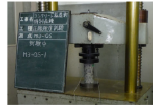
強度の点検状況 (例)
