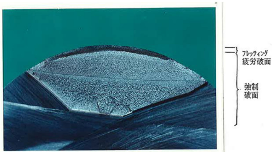
図7 フレット疲労破面例
