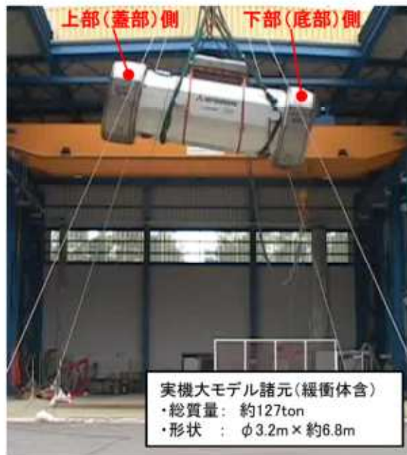
実機大落下試験モデルによる9.3m傾斜落下
