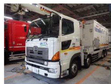
可搬型大容量 海水送水ポンプ車
