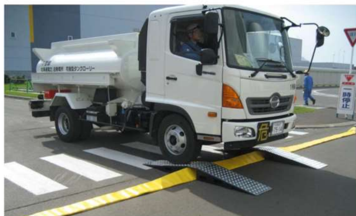
第1図 ホースブリッジの設置状況
