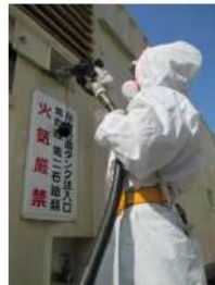
可搬型代替電源車の給油口への 接続 (コネクタ接続) (可搬型代替電源車) (屋外 T.P. 31m)
