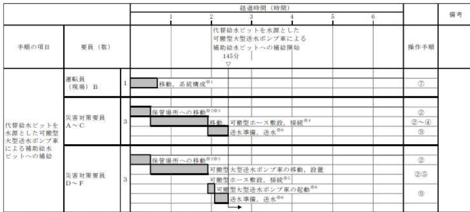
図2.13-9 原水槽を水源とした可搬型大型送水ポンプ車による補助給水ピットへの補給 タイムチャート
