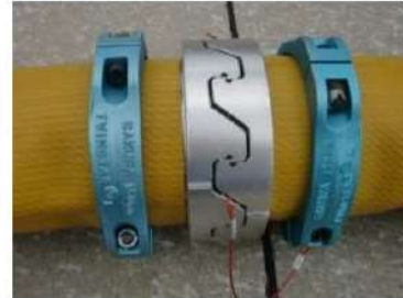
可搬型ホース（150A）接続後
