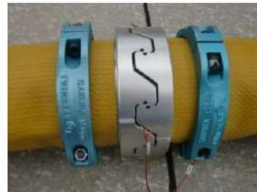
可搬型ホース（150A）接続後
