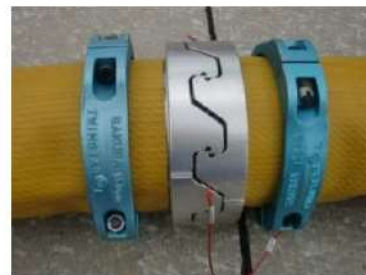
可搬型ホース（150A）接続後
