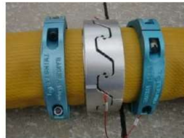
可搬型ホース（150A）接続後
