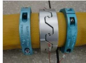
可搬型ホース (150A) 接続後
