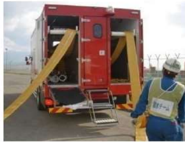
ホース延長・回収車 (送水車用) による可搬型ホース敷設 (屋外 T. P. 33. 1m)
