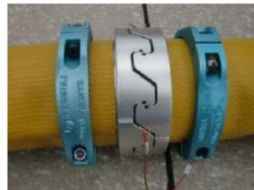
可搬型ホース (150A) 接続後
