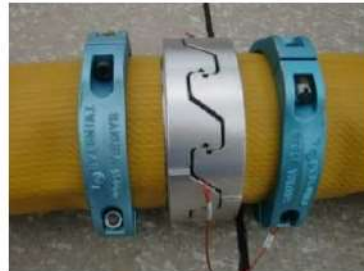
可搬型ホース (150A) 接続後
