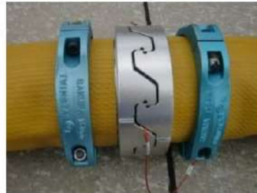
可搬型ホース (150A) 接続後
