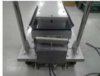
可搬型エアモニタ 検出器側
