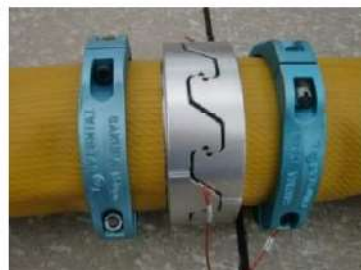
可搬型ホース(150A)接続後
