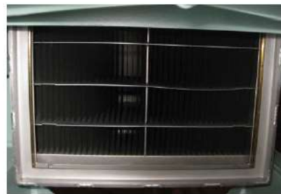
装置底部 (PAR 入口給気口)
