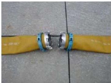
可搬型ホース (150A) 接続前
