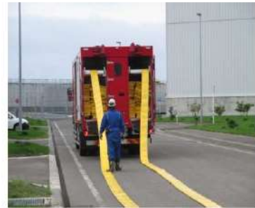
ホース延長・回収車（送水車用）による 可搬型ホース敷設 （屋外 T. P. 10. 3m）
