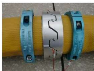
可搬型ホース（150A）接続後
