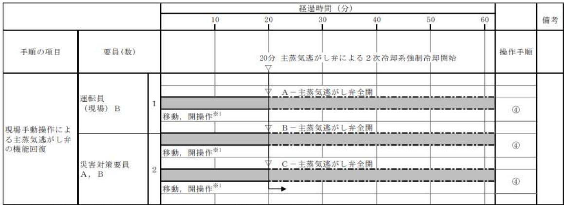
図2.5-6 主蒸気逃がし弁（現場手動操作）による主蒸気逃がし弁の機能回復 タイムチャート※
