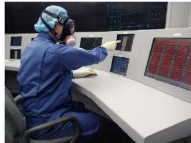
加圧器逃がし弁開操作 (中央制御室)
