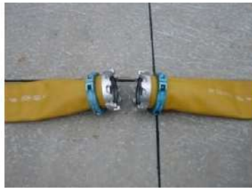
可搬型ホース（150A）接続前
