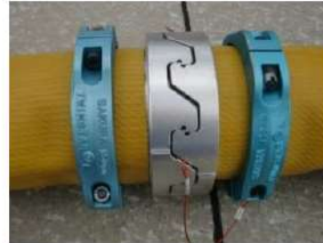
可搬型ホース（150A）接続後
