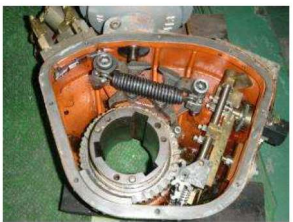
図 1 1 ツインパワー弁駆動部外観及び内部観察
