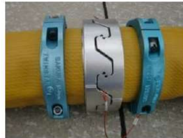
可搬型ホース（150A）接続後
