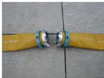
可搬型ホース (150A) 接続前
