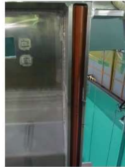
ゲートパッキンの装着状況
