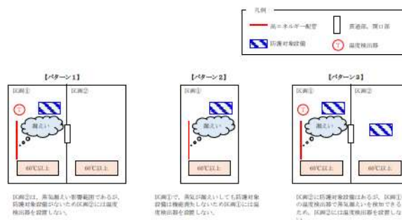
図2 区画配置温度検出器設置概念図
