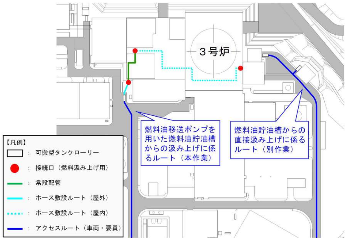
第7図 ディーゼル発電機燃料油移送ポンプ及び可搬型タンクローリーを用いた燃料補給のルート概略図
