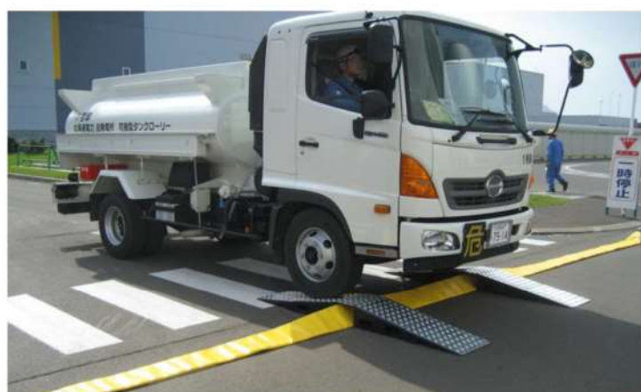
第1図 ホースブリッジの設置状況
