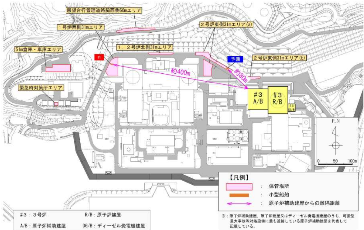
小型船舶と原子炉補助建屋との離隔距離
