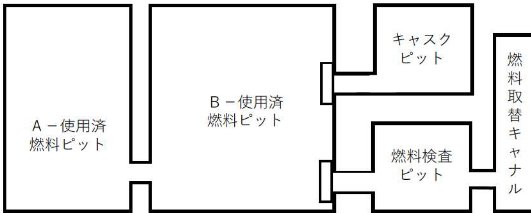
第5図 使用済燃料ピット配置図
