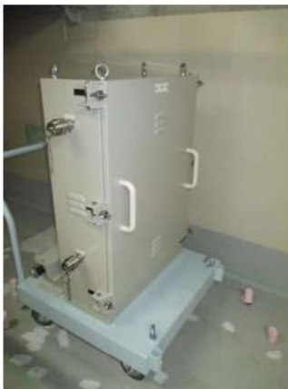
可搬型アニュラス水素濃度計測ユニット (原子炉建屋 T. P. 24. 8m)
