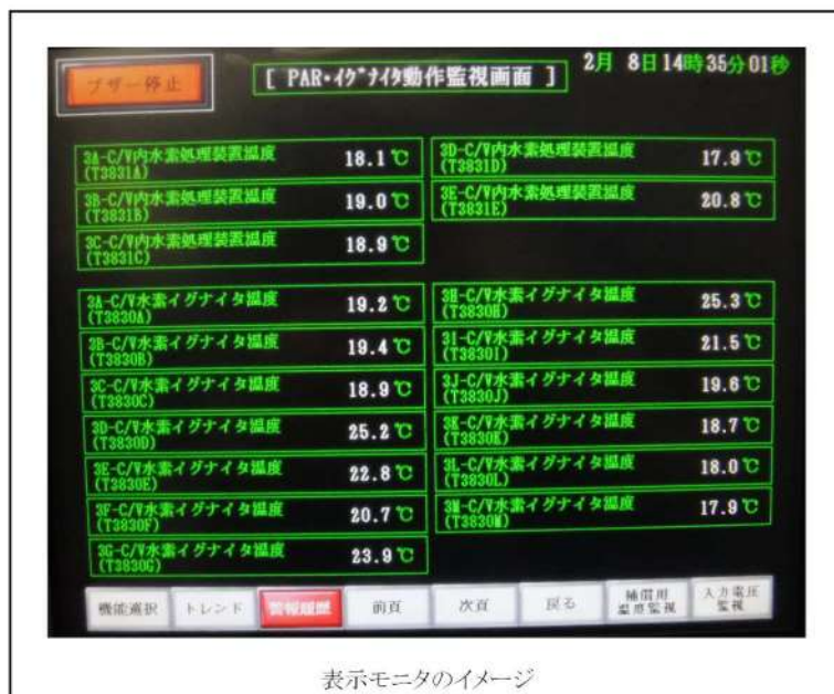
図2 格納容器水素イグナイタ温度監視装置の概要
