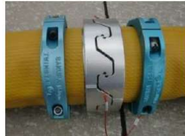
可搬型ホース(150A)接続後
