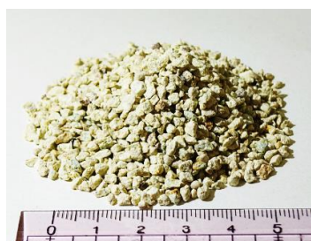
ゼオライトの外観 (敷設した物と同製品)
