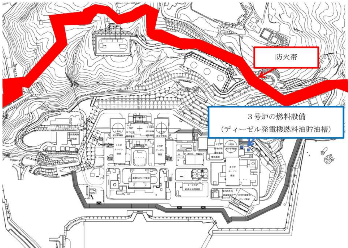
第 41-1-11 図：防火帯と燃料設備（ディーゼル発電機燃料油貯油槽）の位置関係
