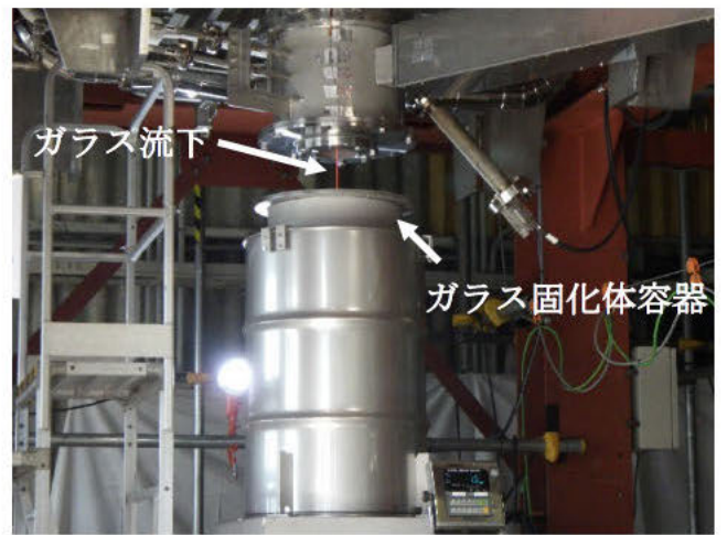
写真-2 カレット溶融試験の状況 (3/23)
