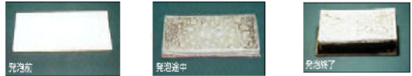
加熱前 200~250℃で発泡し 断熱層を形成 発泡完了
