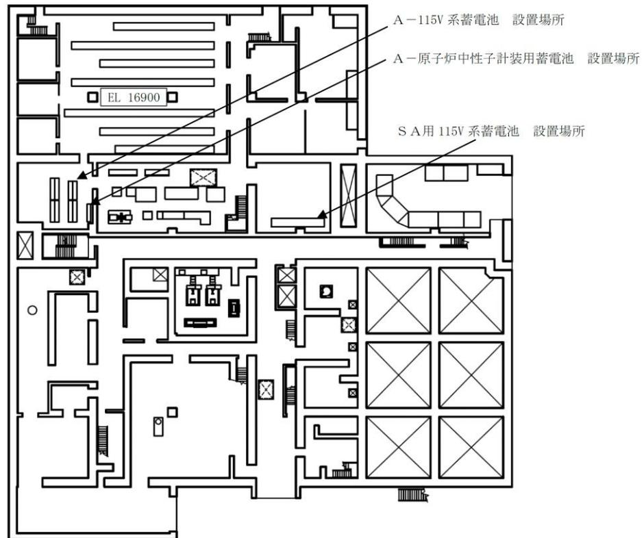
第 57-5-3 図 直流電源設備 設置場所 (2 / 3)
