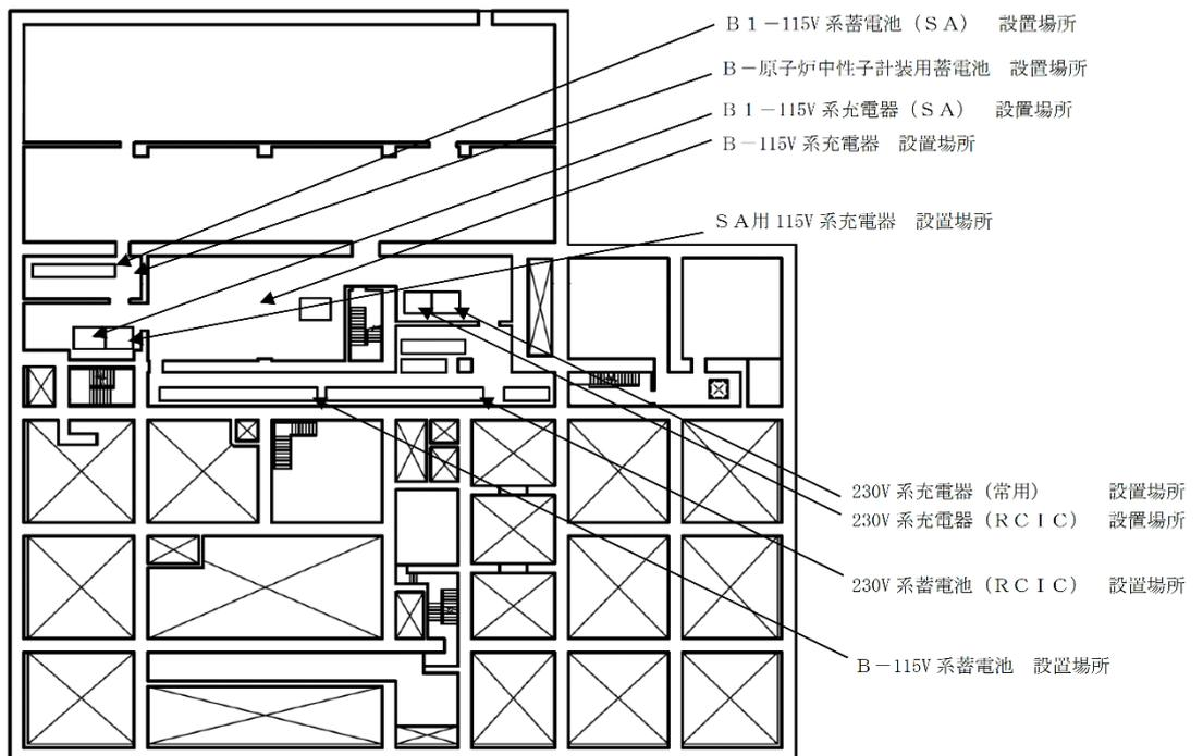
第 57-5-3 図 直流電源設備 設置場所 (1 / 3)
