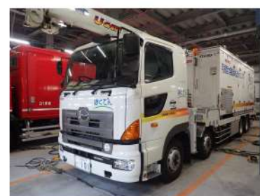
可搬型大容量 海水送水ポンプ車
