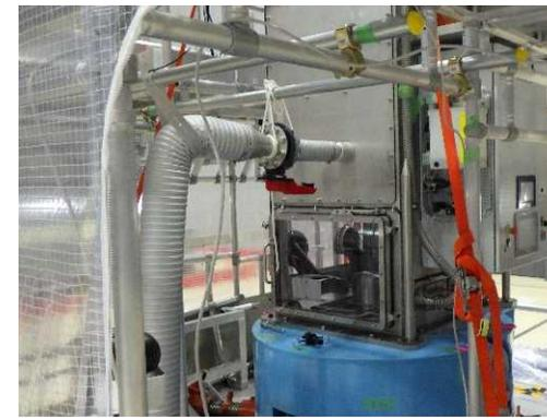
換気ユニットの換気風量確認
