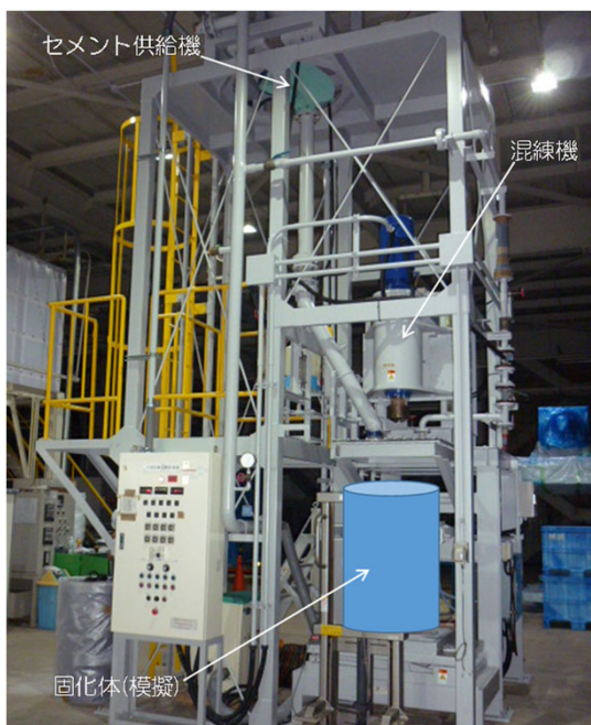
セメント固化設備の工学規模試験装置
