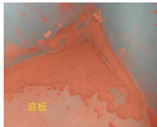
ケーシングの腐食の状況
