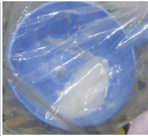
容器充填用受け内の スラリーの外観(上澄み水添加後)
