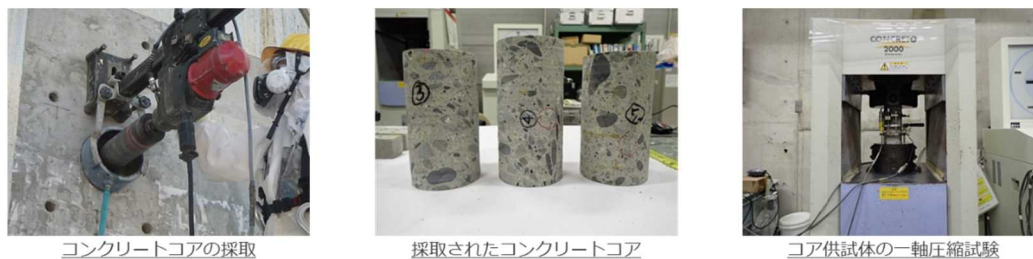
図 25 コンクリート強度調査状況
