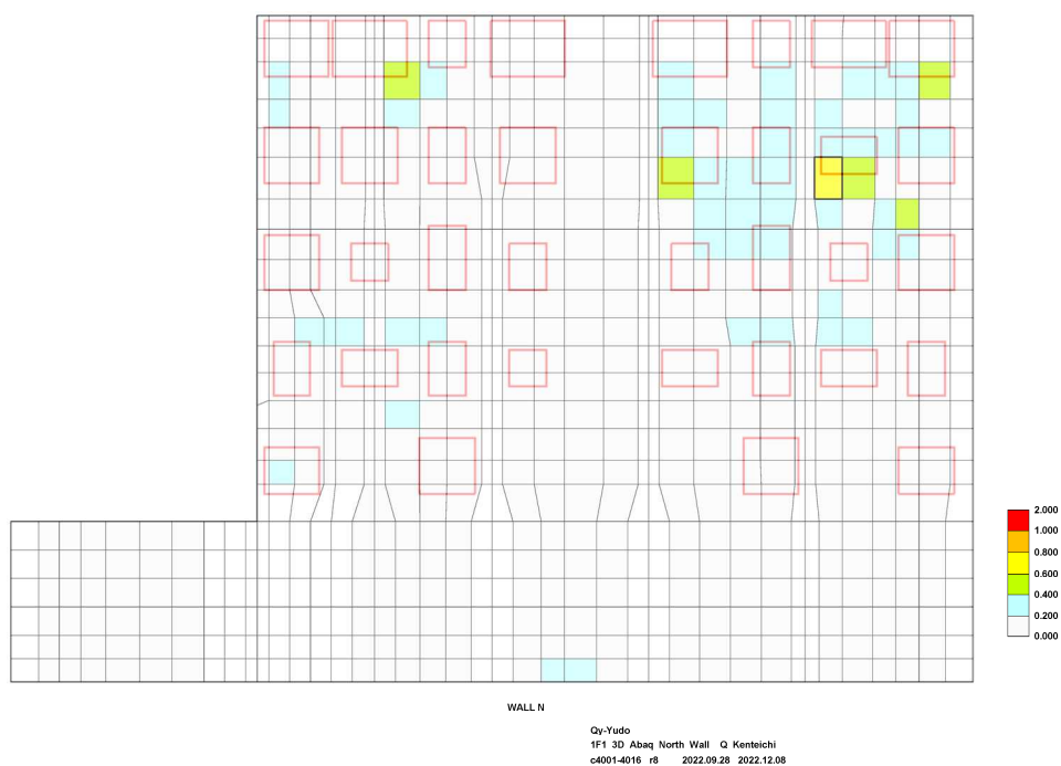
図-1.16 面外せん断力の検定比 (建屋外壁北面)
