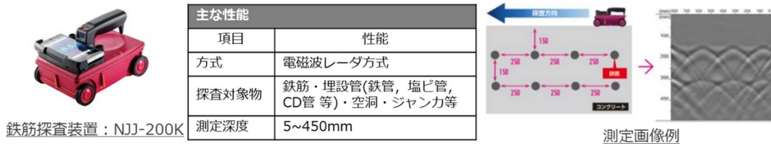
図 72 鉄筋探査装置
