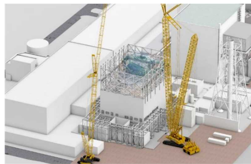
図6-1 仮設構台設置完了までのイメージ図*
