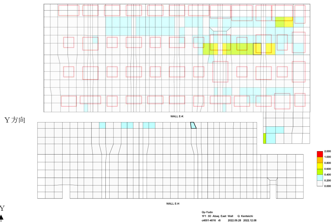
図-1.13 面外せん断力の検定比 (建屋外壁東面)
