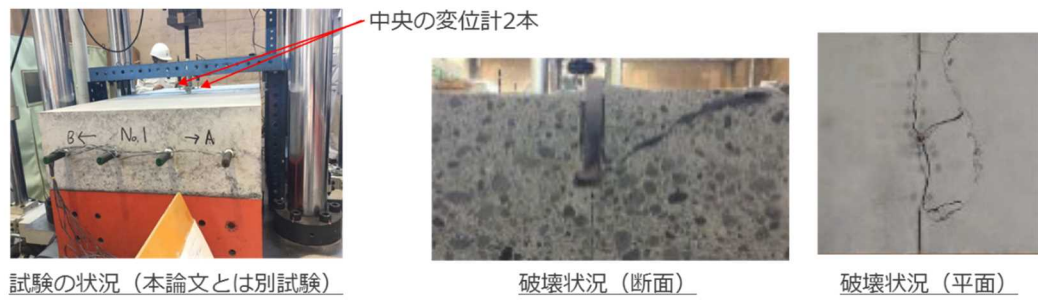
図 22 試験状況と試験体破壊状況
