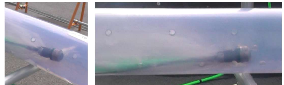
図8 管内清掃装置進行時の様子 (添付5-4(4)図)
