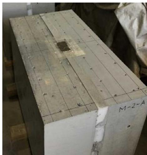
手順5：止水材（モルタル）注入完了
