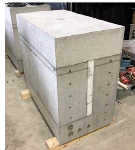
手順6：上部設置（試験体完成）
