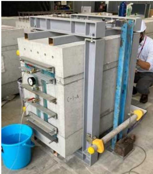
写真1. 試験体（加圧側）
