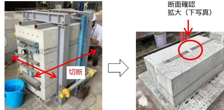
試験体切断位置と切断断面
