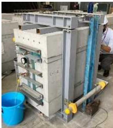
写真1 加圧試験状況
