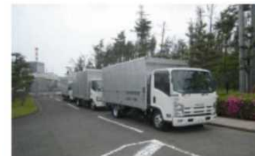
可搬型代替低圧電源車
