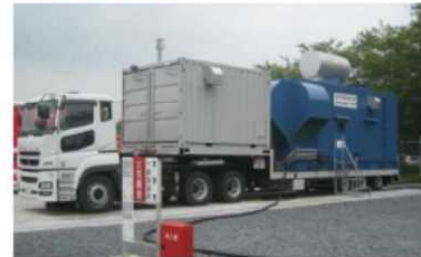
常設代替高圧電源装置
