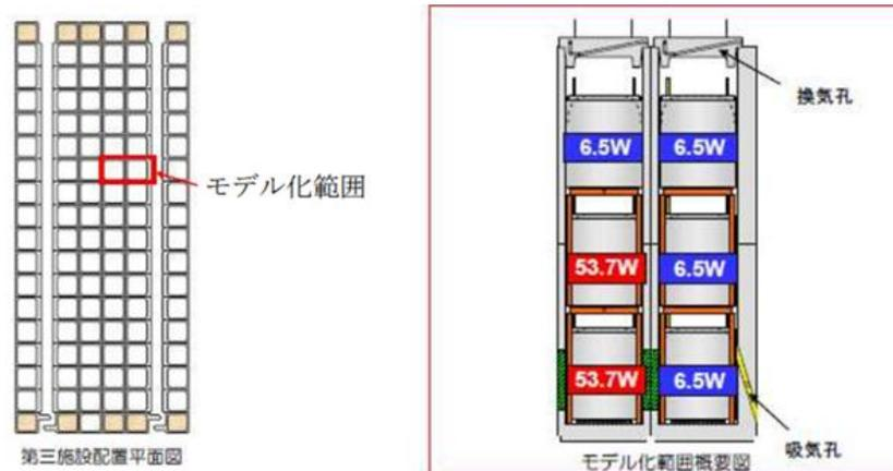
図 2.14.5-1 第三施設温度評価の評価体系概念
