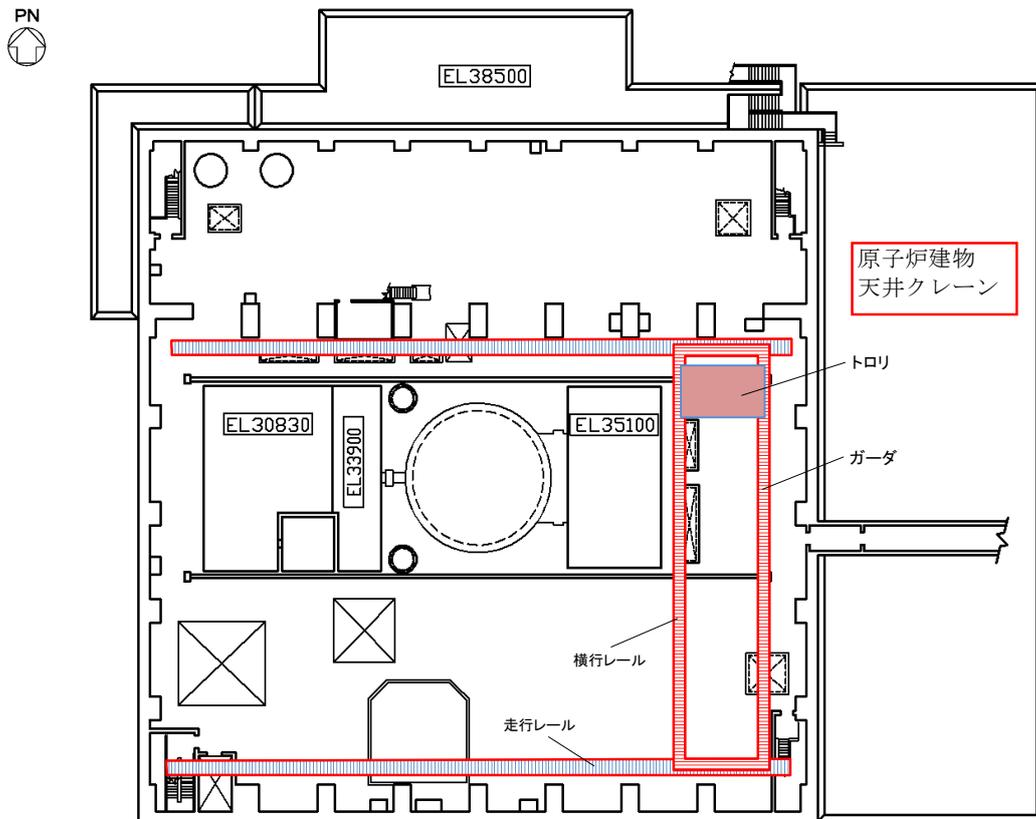
図 6-3-2 島根原子力発電所 2号機 建物内主要クレーン位置関係概要図 (1/3)
