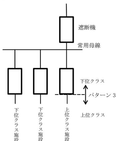
図5-2-2 受電系統概念図（パターン3）
