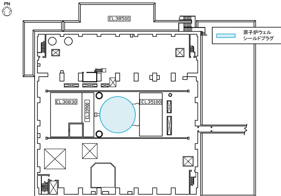
図 6-3-3 島根原子力発電所 2 号機 原子炉ウェルシールドプラグ及びガンマ線遮蔽壁
