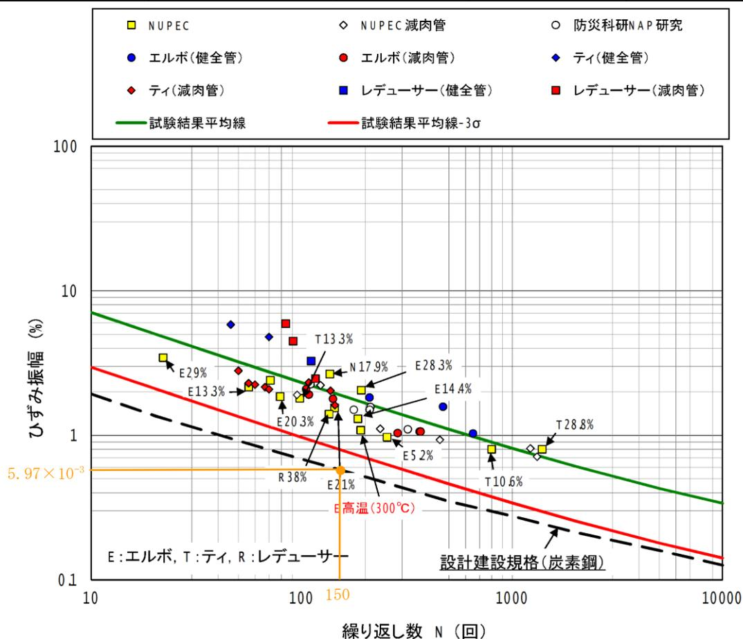
\* 図中の記号は、E：エルボ、T：ティ、R：レデューサ。パーセントで表された数値は、ラチェットひずみ（残留ひずみ）を示す。
