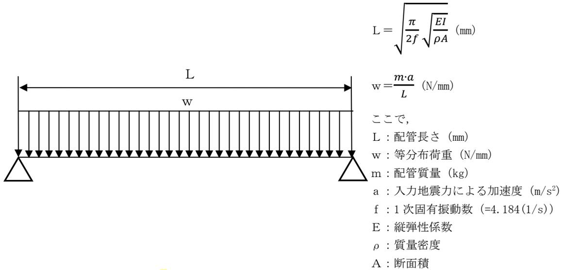
図 2.2-3 等分布荷重が作用する両端単純支持のモデル概要
