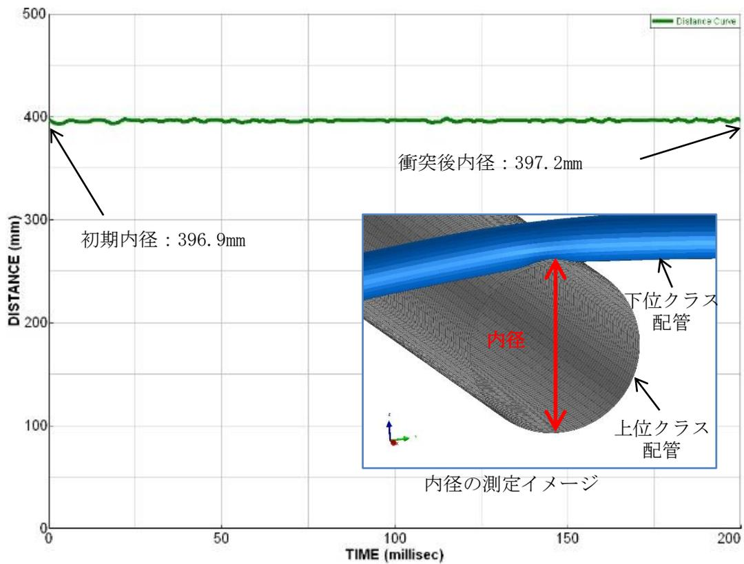
図 3.4-7 上位クラス配管の内径の時刻歴
