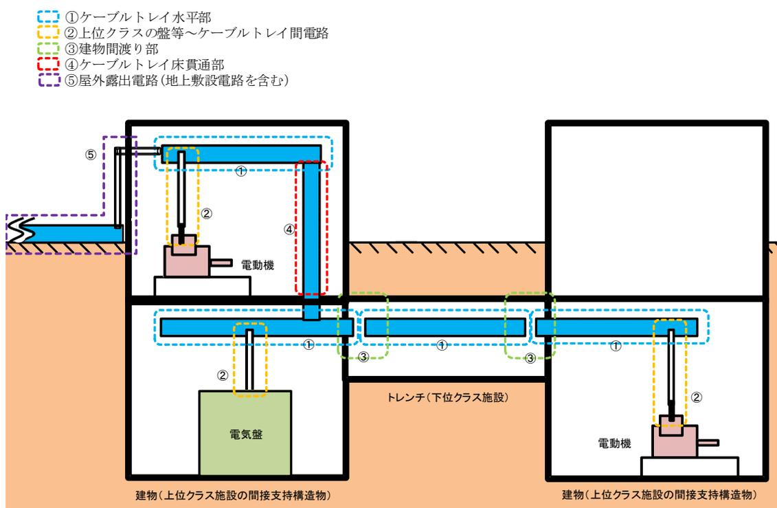
図 1-1 上位クラス電路の敷設方法及び評価部位
