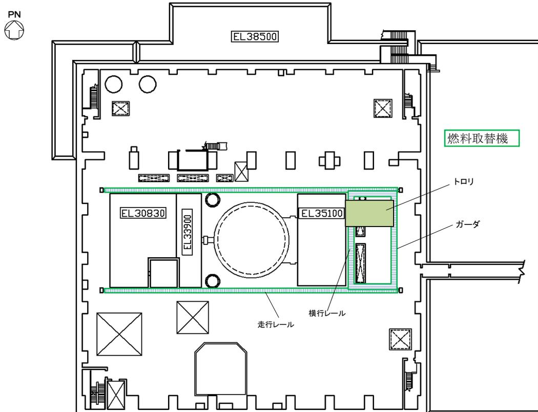
図 6-3-2 島根原子力発電所 2 号機 建物内主要クレーン位置関係概要図 (2/3)
