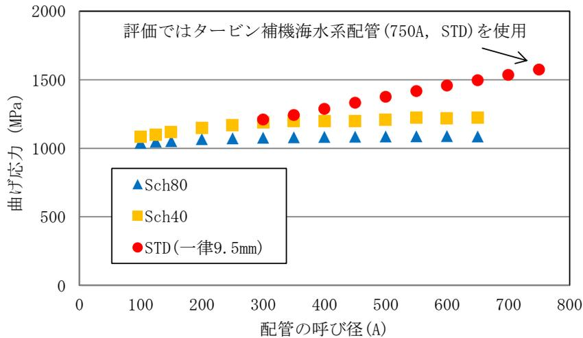
図 2.2-4 口径、板厚と曲げ応力の関係（両端単純支持条件の配管）
