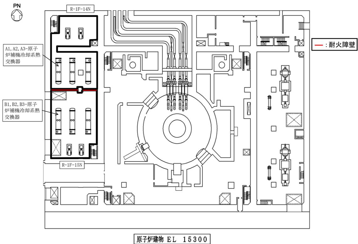
図 6-3-5 島根原子力発電所 2号機 上位クラス施設と耐火障壁の位置関係概要図 (1/3)
