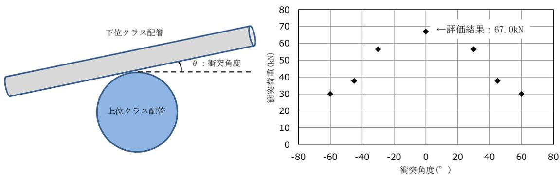
図 3.4-5 衝突角度と衝突荷重の関係
