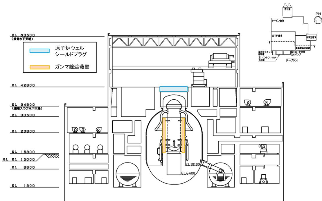
図 6-3-3 島根原子力発電所 2号機 原子炉ウェルシールドプラグ及びガンマ線遮蔽壁
