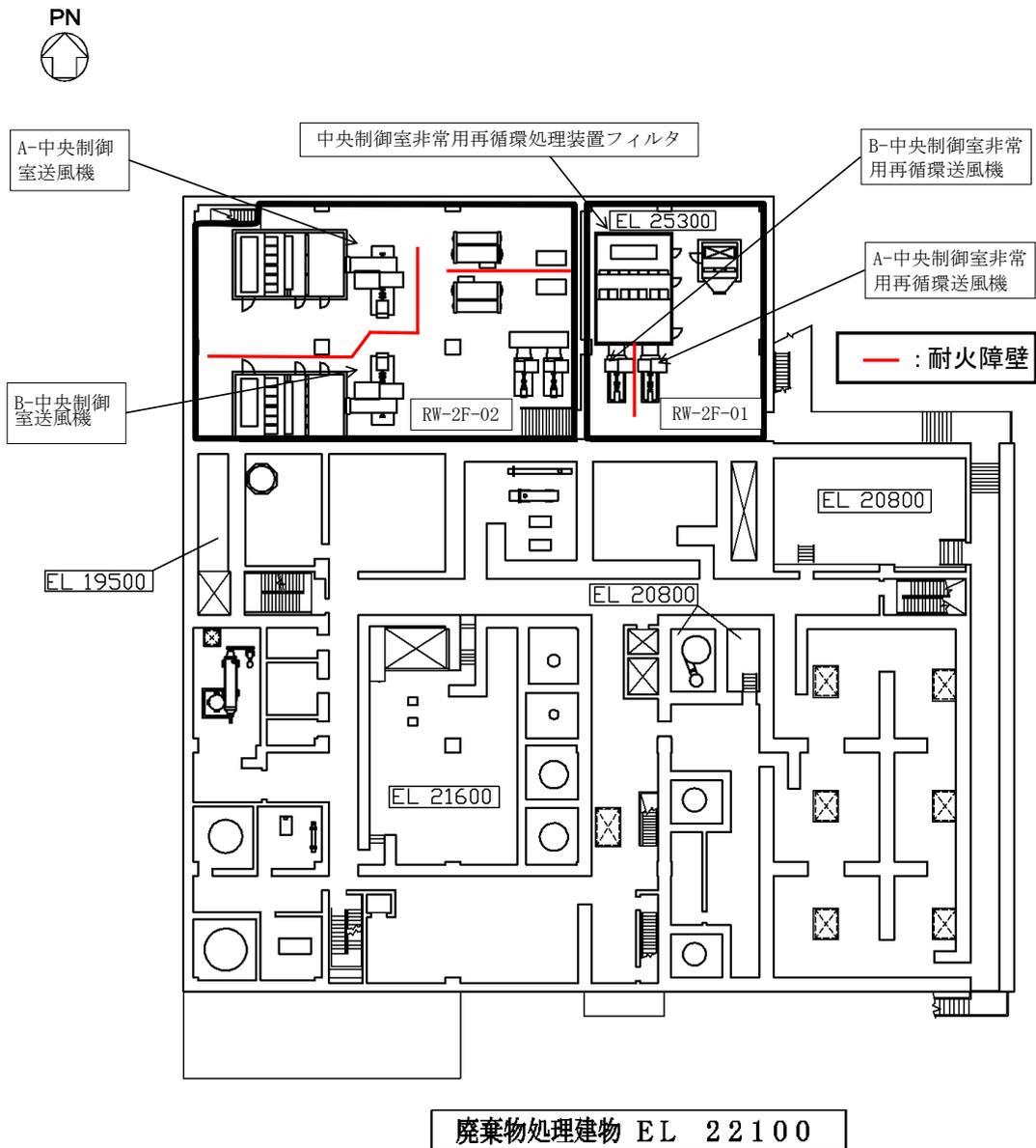
図 6-3-5 島根原子力発電所 2 号機 上位クラス施設と耐火障壁の位置関係概要図 (3/3)
