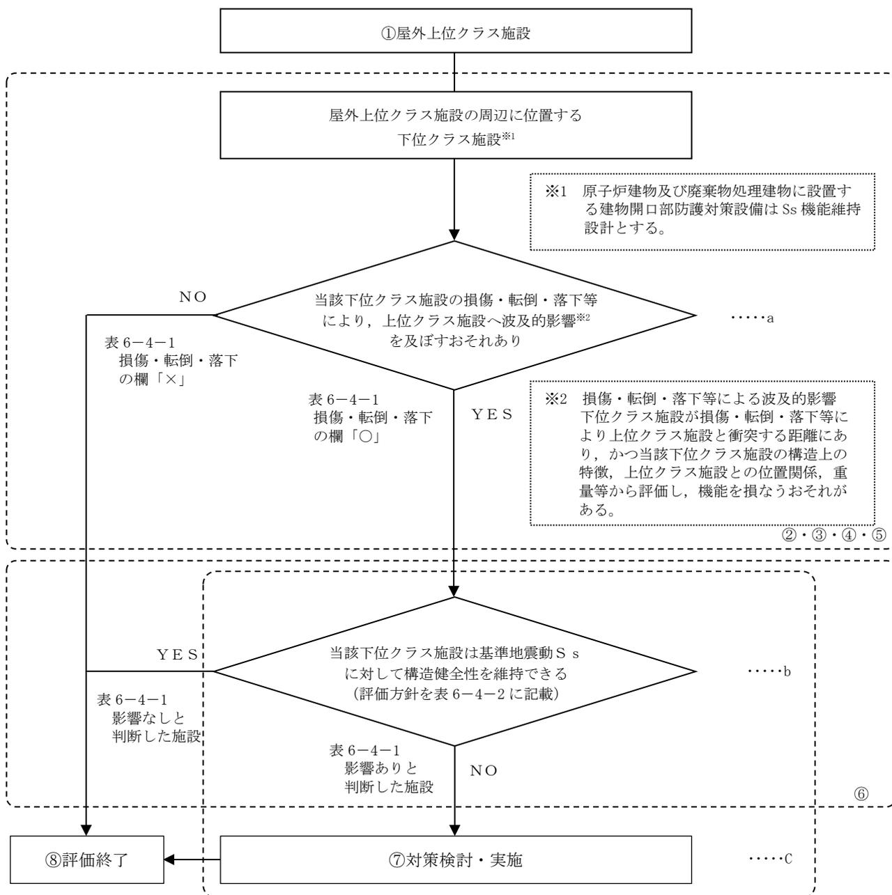
図 5-4 損傷，転倒，落下等により屋外上位クラス施設へ影響を及ぼす
