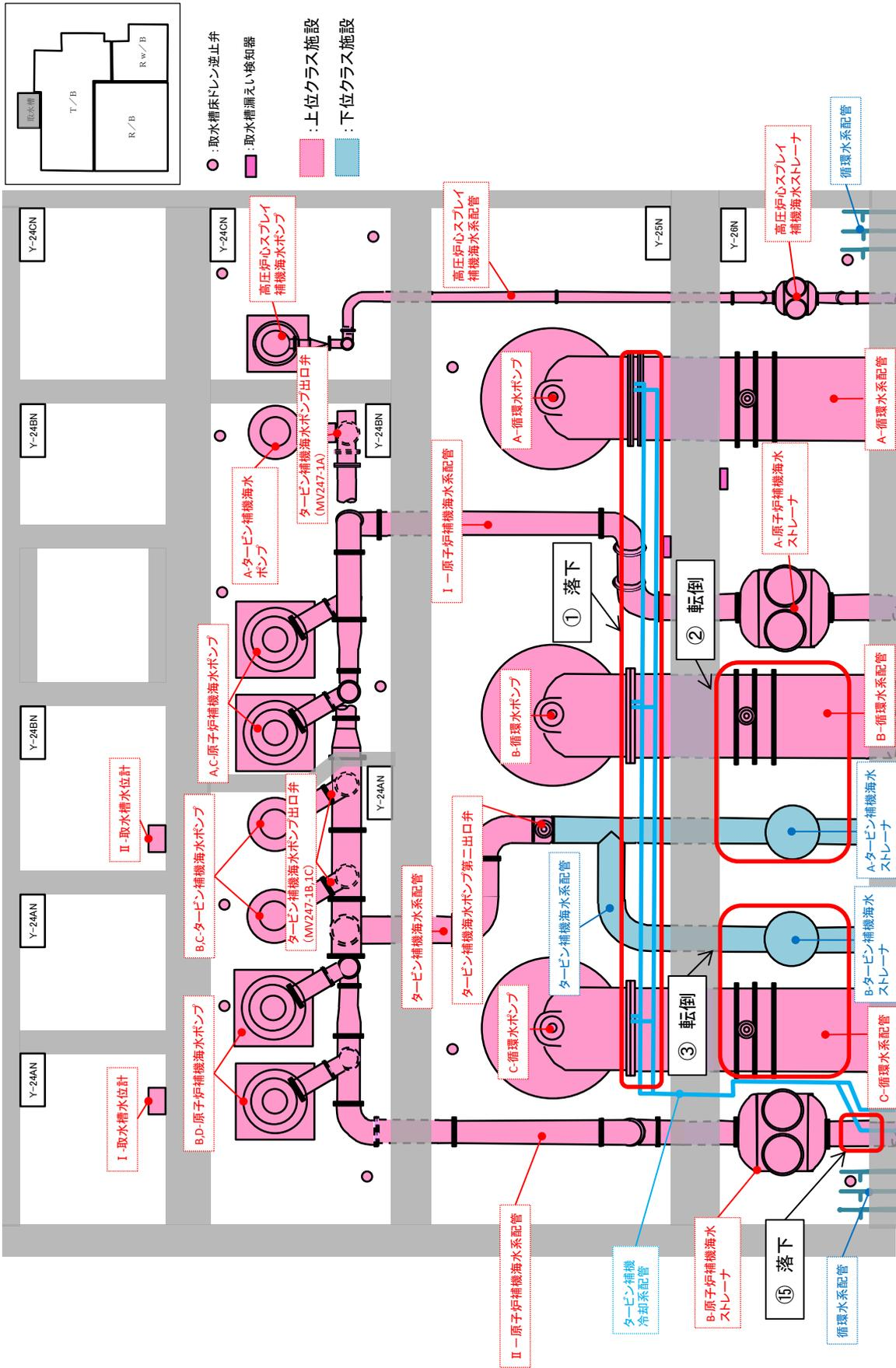
図 4-5 上位クラス施設と下位クラス施設の位置関係 (取水槽) (1/5)
