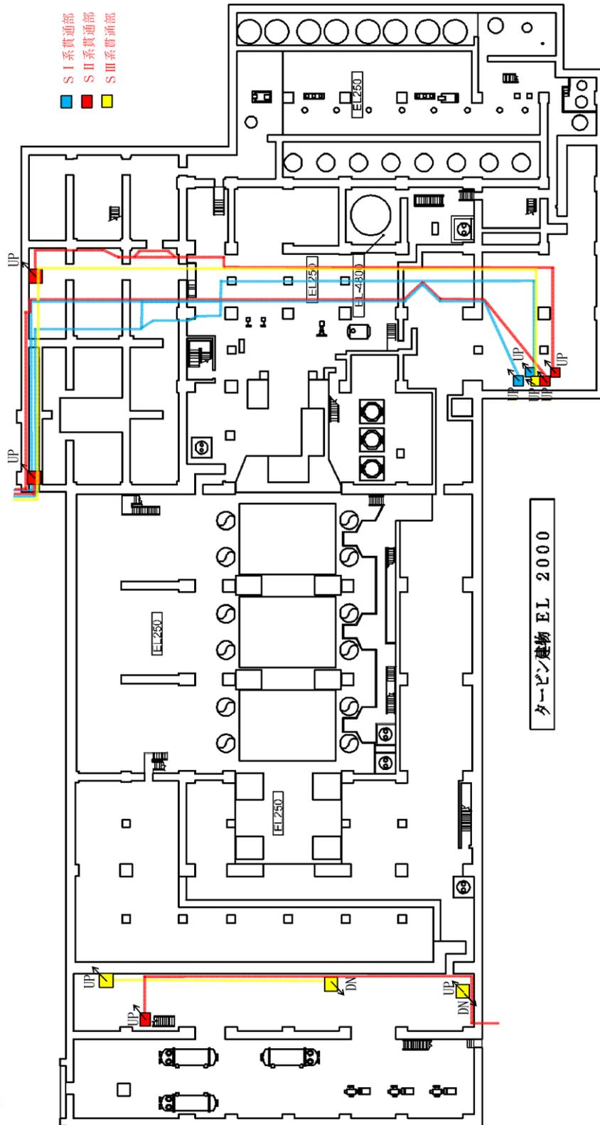
図 3-1 島根原子力発電所 2 号機 上位クラス 電路貫通部配置図 (S I, S II, S III系) (7/12)
