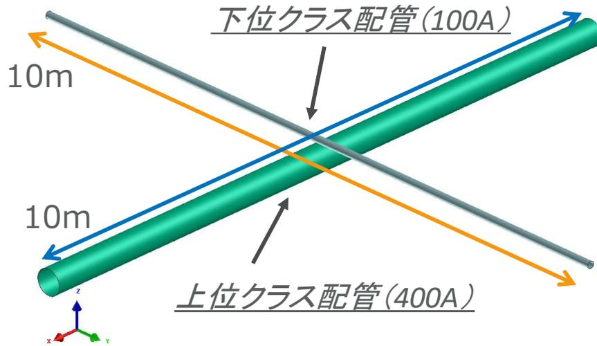
図 3.4-2 解析モデルの概要
