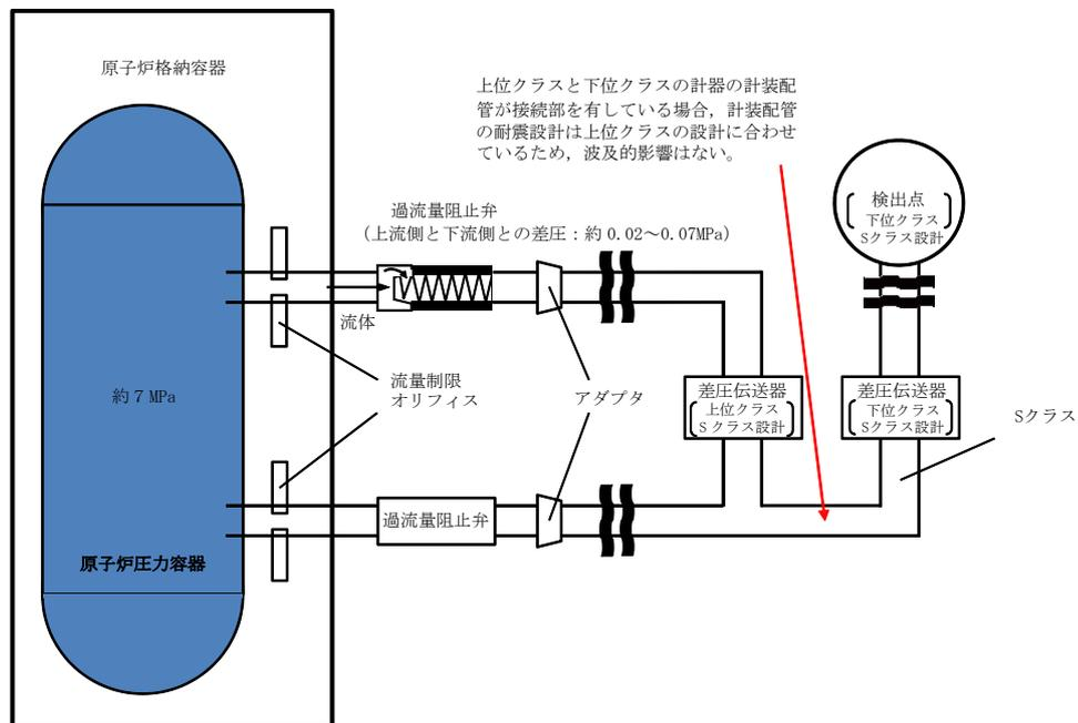
図5-2-4 計装配管の耐震設計概念図
