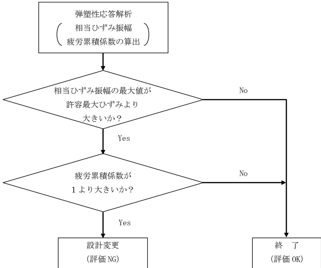
図 2.2-1 配管の弾塑性応答解析評価フロー
