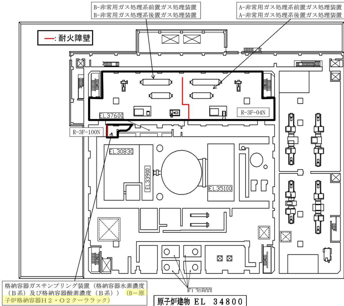
図 6-3-5 島根原子力発電所 2 号機 上位クラス施設と耐火障壁の位置関係概要図 (2/3)
