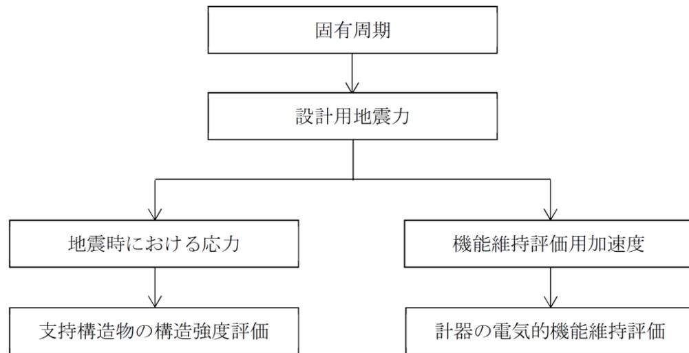
図2-1 地震加速度の耐震評価フロー
