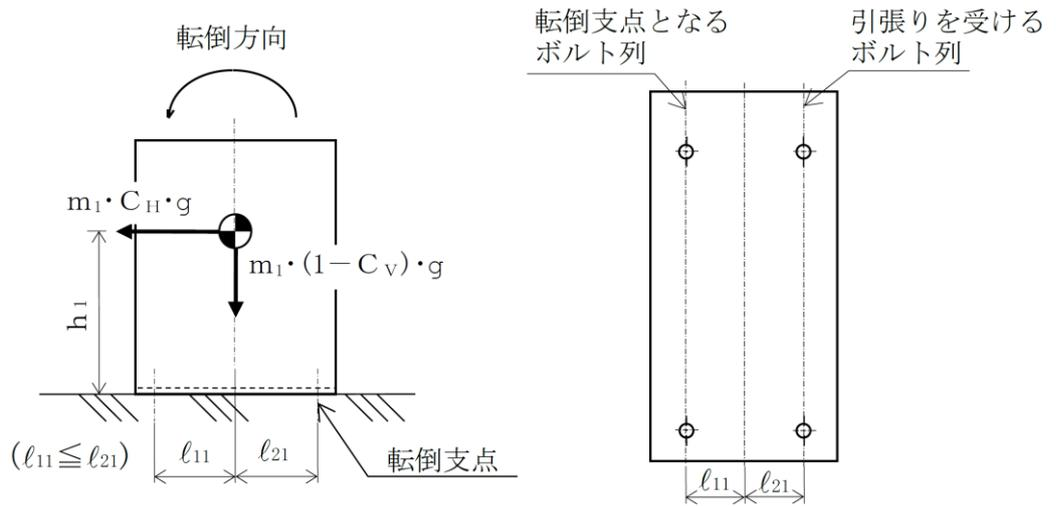
図5-1 計算モデル（短辺方向転倒） $(1 - C_V) \geq 0$
