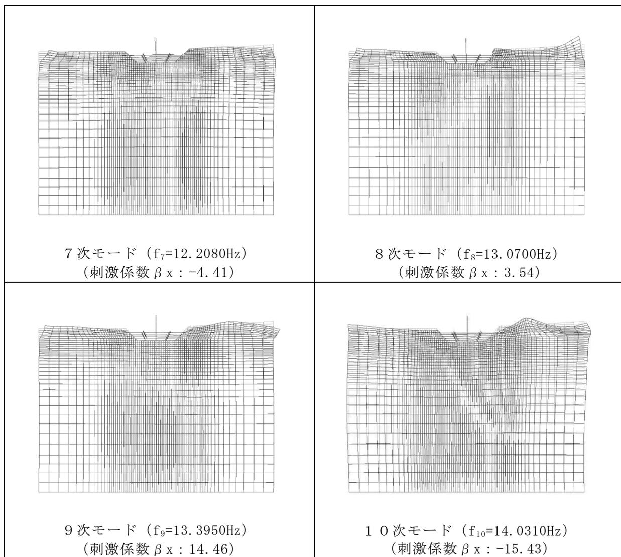
図 3-16 固有値解析結果 (モード図) (E-E 断面)
