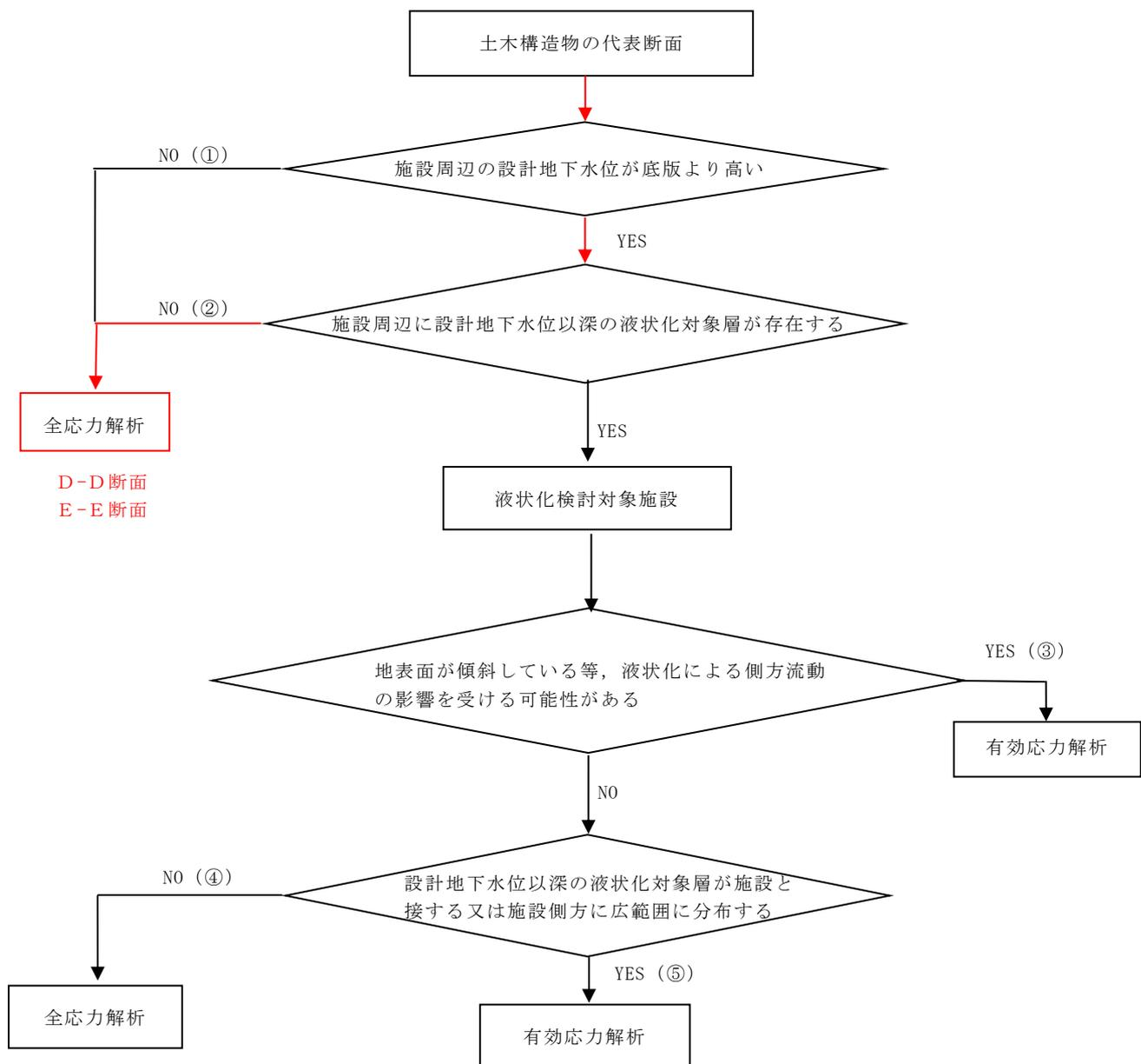
図 3-1 解析手法の選定フロー
