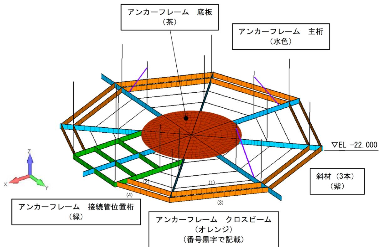
図 2-17 アンカーフレーム部応力照査箇所
