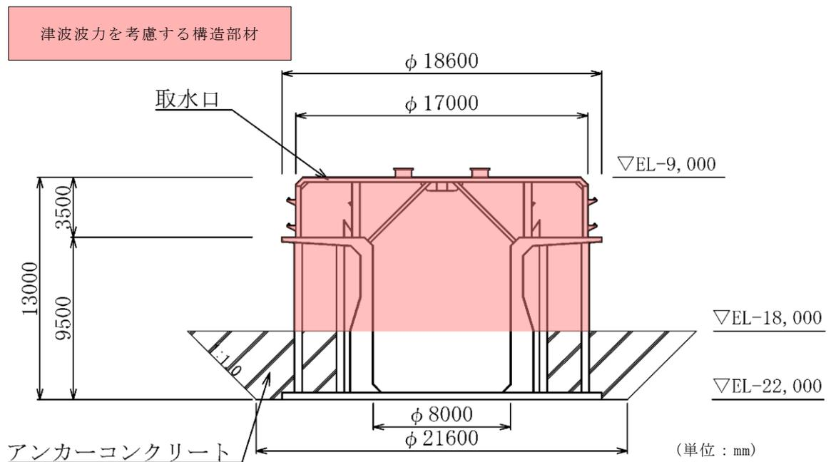
図 3-1 取水口断面図
