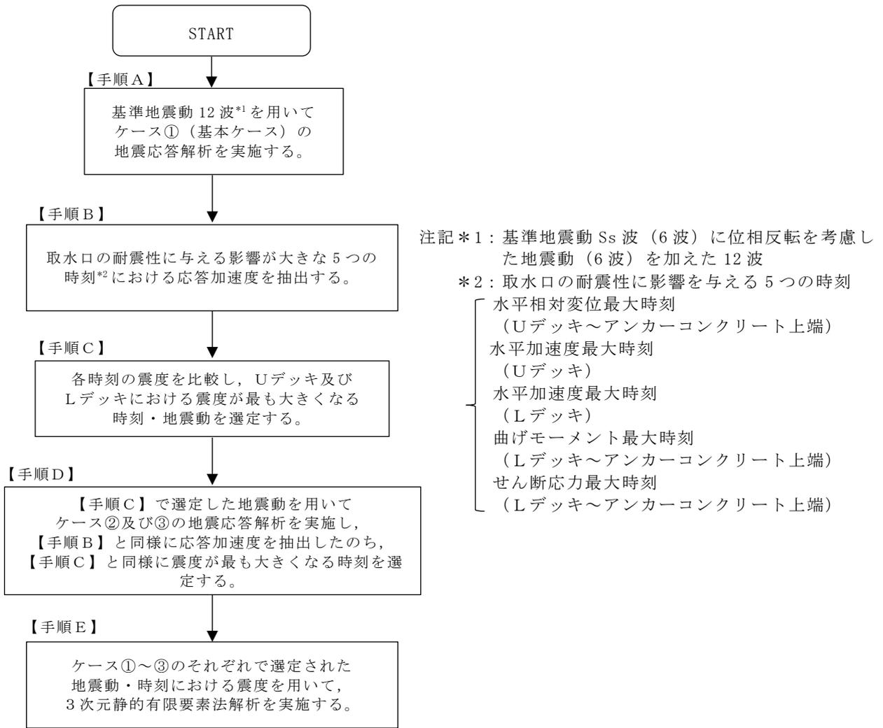
図 3-21 応力解析を実施する地震動の選定フロー
