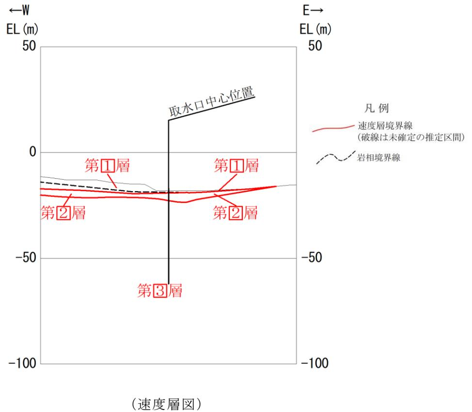
図 2-11 取水口 評価対象断面図 E-E断面 (東西断面)
