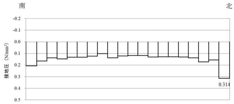
図 6-13 基礎地盤の最大接地圧分布図
