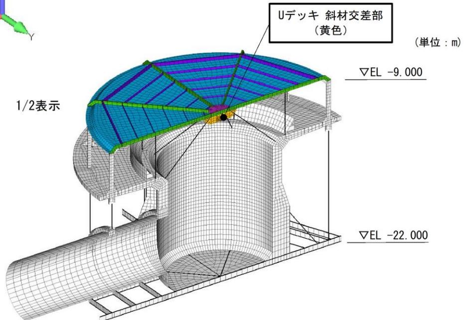
図 4-2 Uデッキ部応力照査箇所
