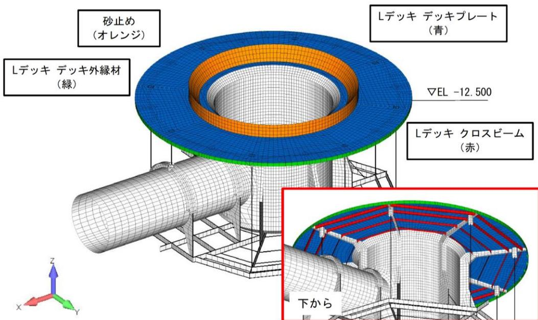
図 4-4 Lデッキ部応力照査箇所
