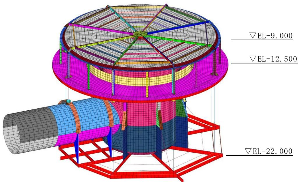
注：上部はアンカーコンクリート（茶色）を表示した解析モデル図
