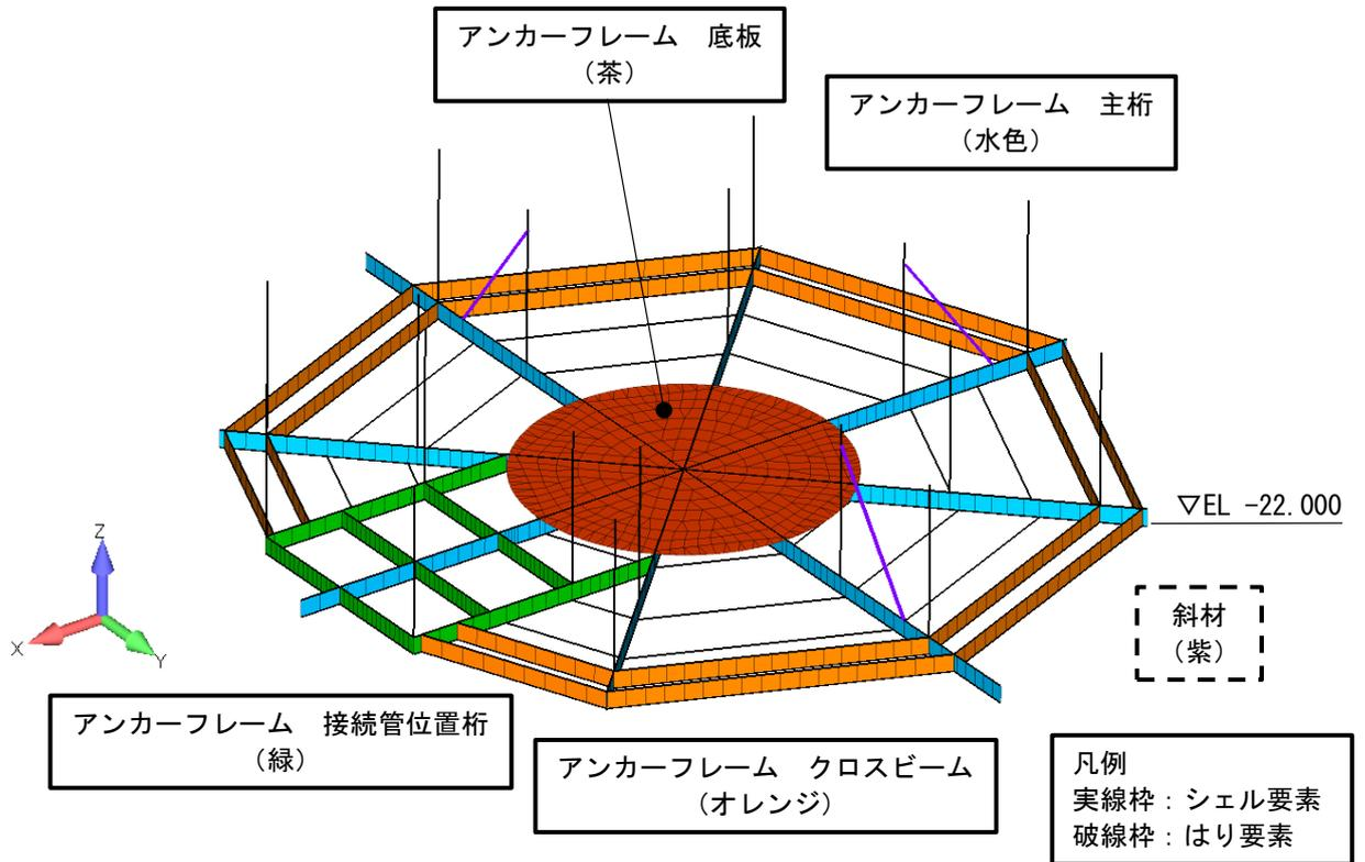
図 4-7 アンカーフレーム部応力照査箇所
