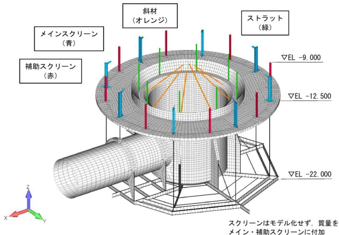
図 2-13 Uデッキ～Lデッキ部応力照査箇所
