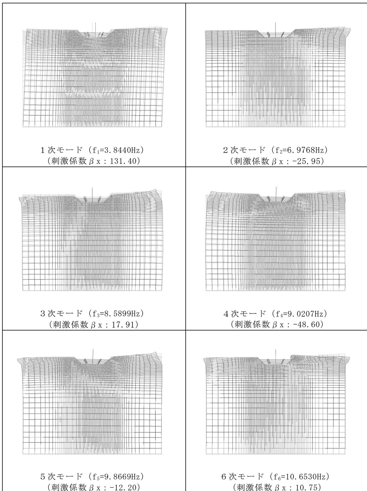
図 3-15 固有値解析結果 (モード図) (E-E断面)
