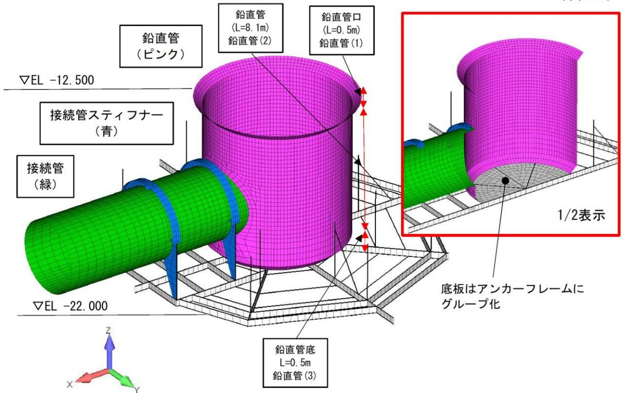
図 2-16 鉛直管及び接続管部応力照査箇所
