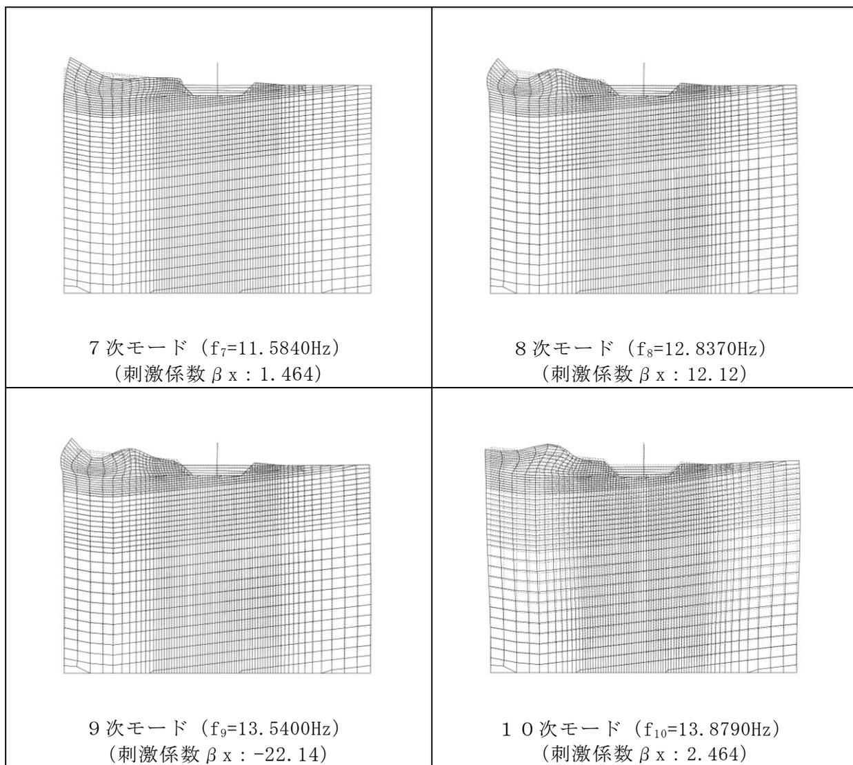
図 3-14 固有値解析結果 (モード図) (D-D断面)
