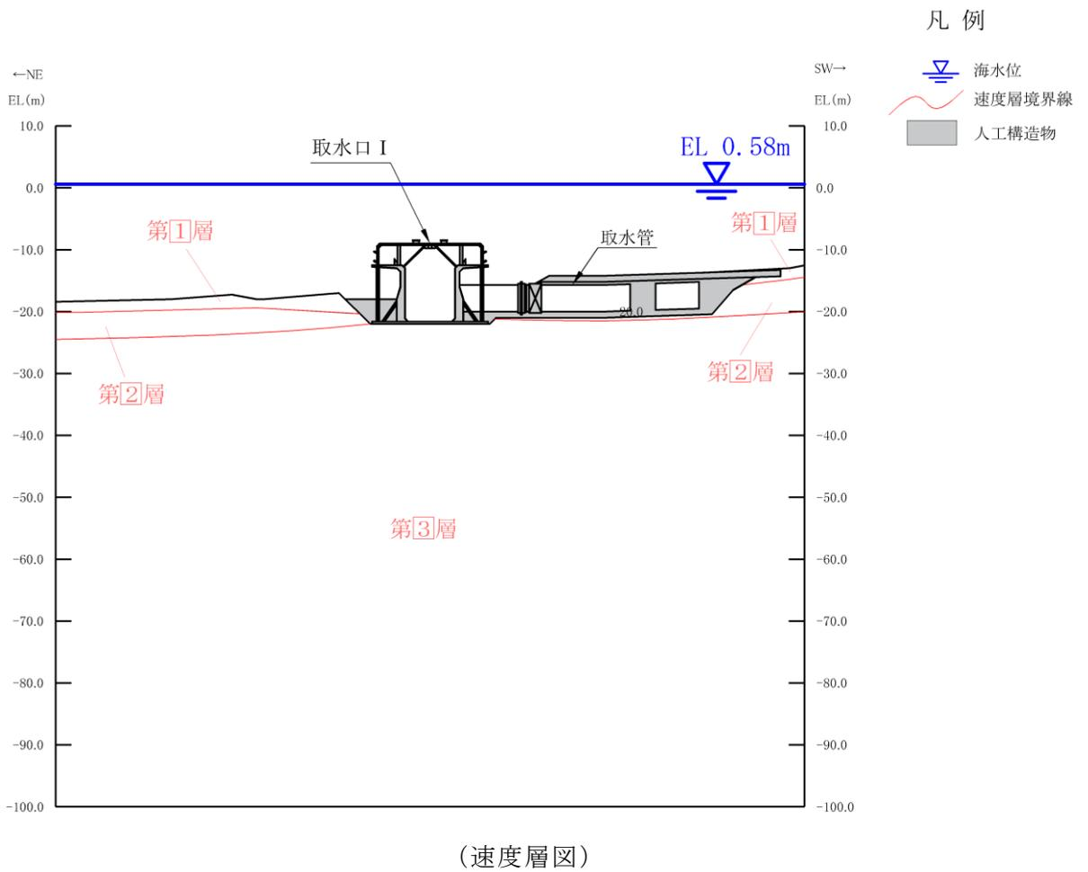
図 2-7 (1) 取水口 地質断面図 (A-A断面)
