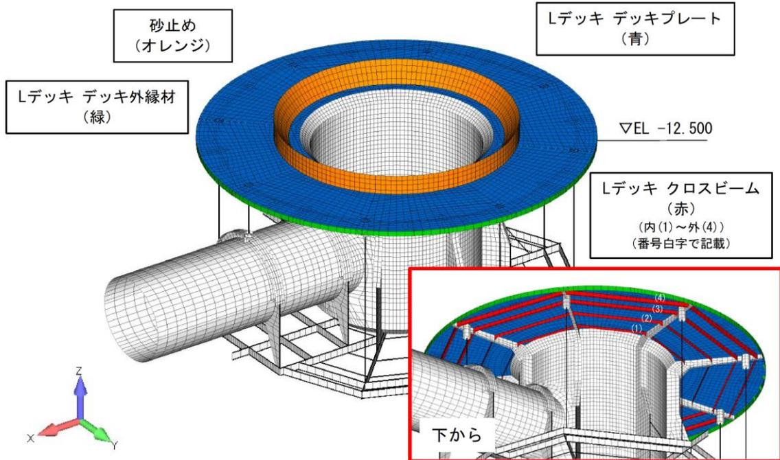
図 2-14 Lデッキ部応力照査箇所
