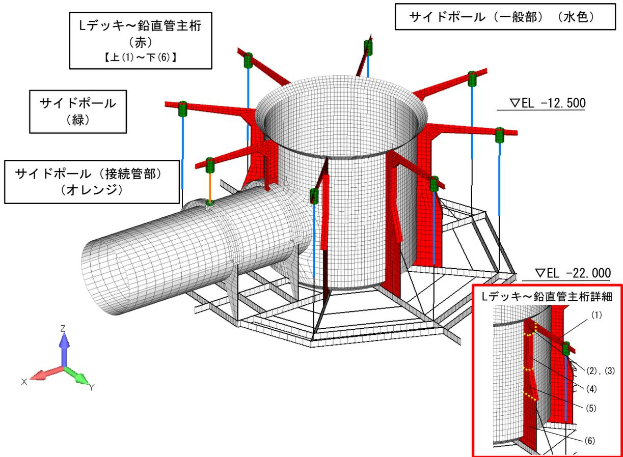
図 2-15 Lデッキ～アンカーコンクリート部応力照査箇所
