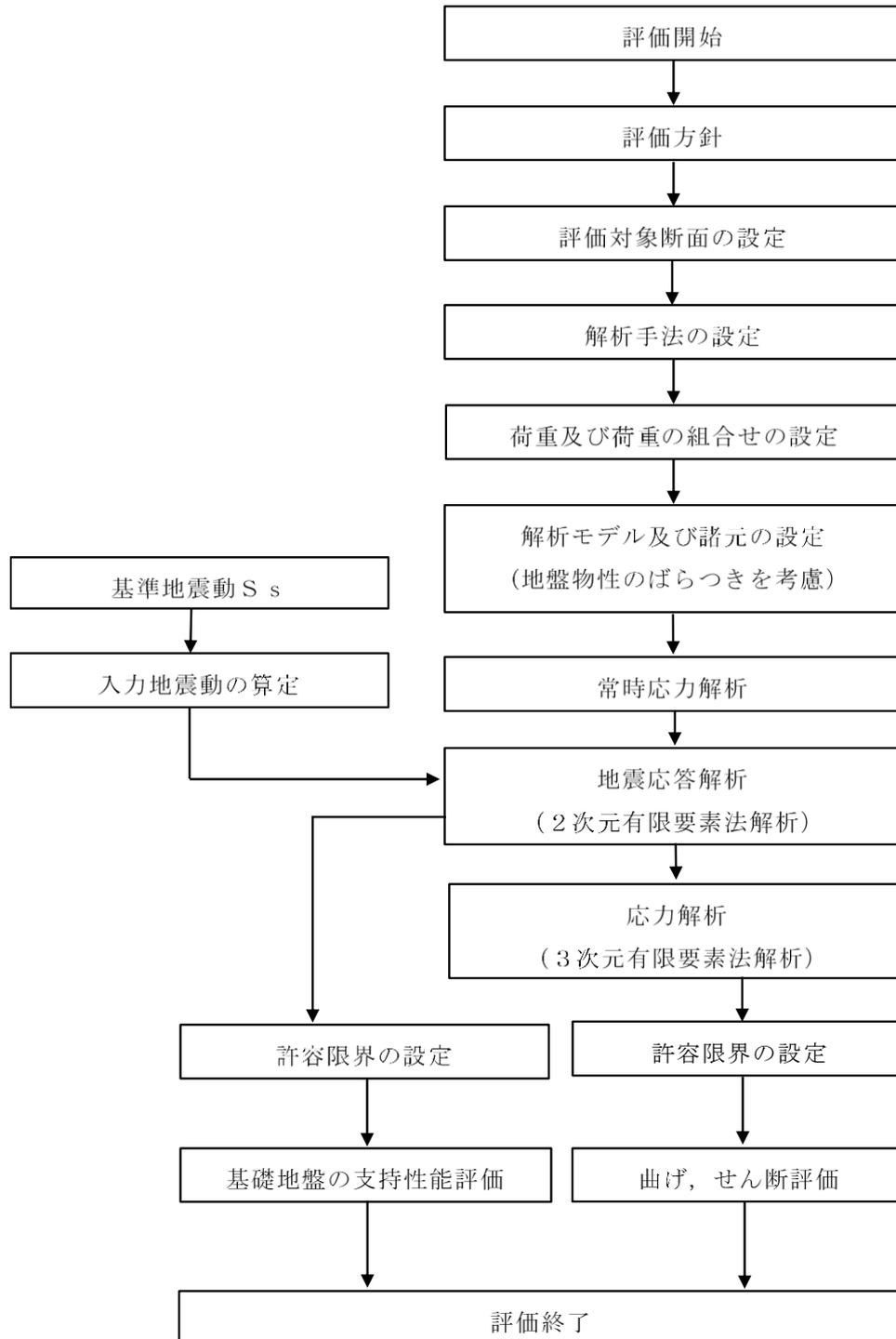
図 2-18 取水口 地震応答解析及び耐震評価フロー
