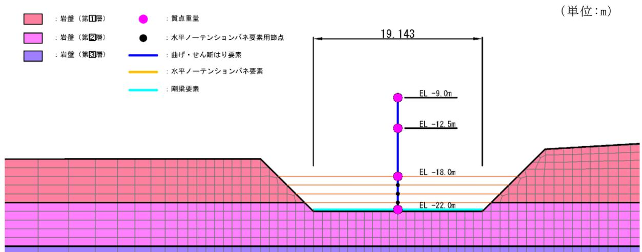
図 3-7 構造物と地盤間のモデル化概念図 (E-E 断面)
