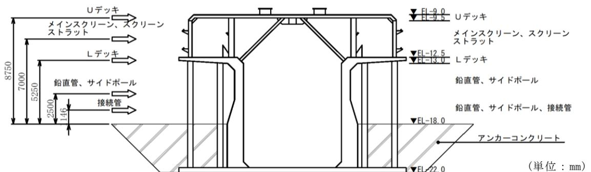
図 4-1 アンカーコンクリート上端部のモーメント算出概念図
