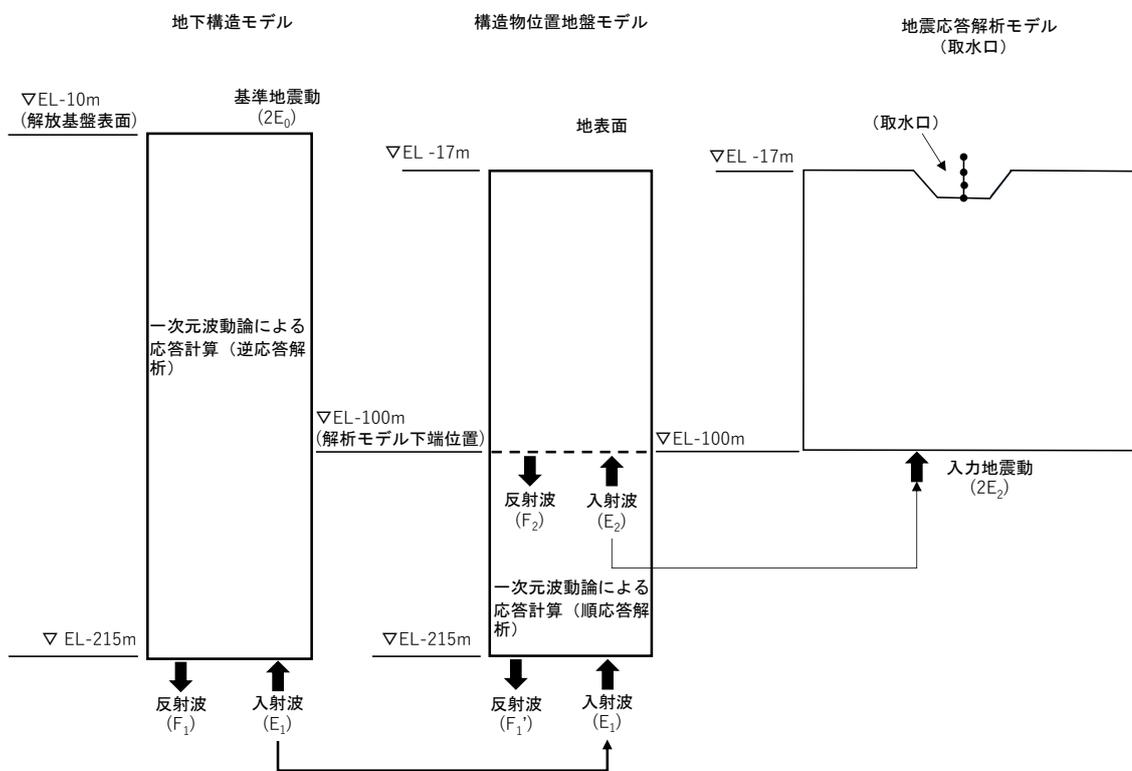
図3-22 入力地震動算定の概念図
