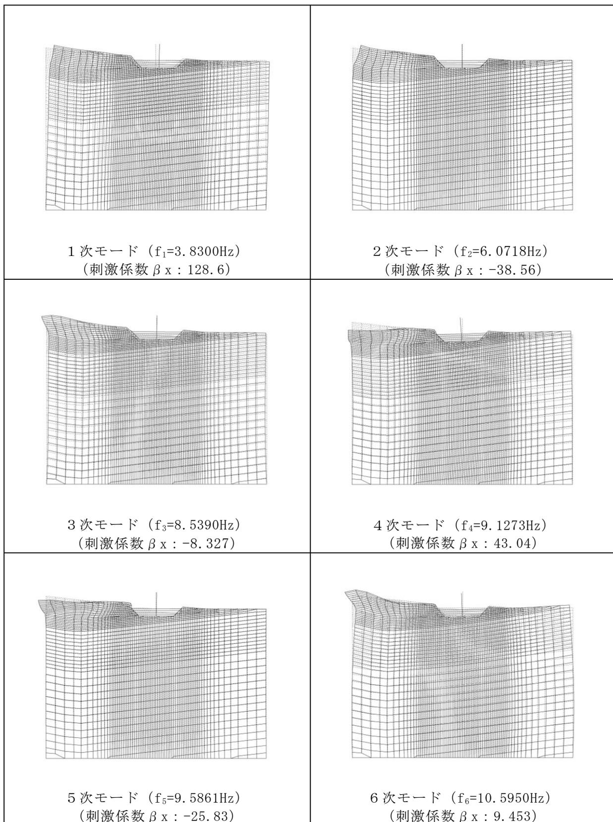
図 3-13 固有値解析結果 (モード図) (D-D断面)
