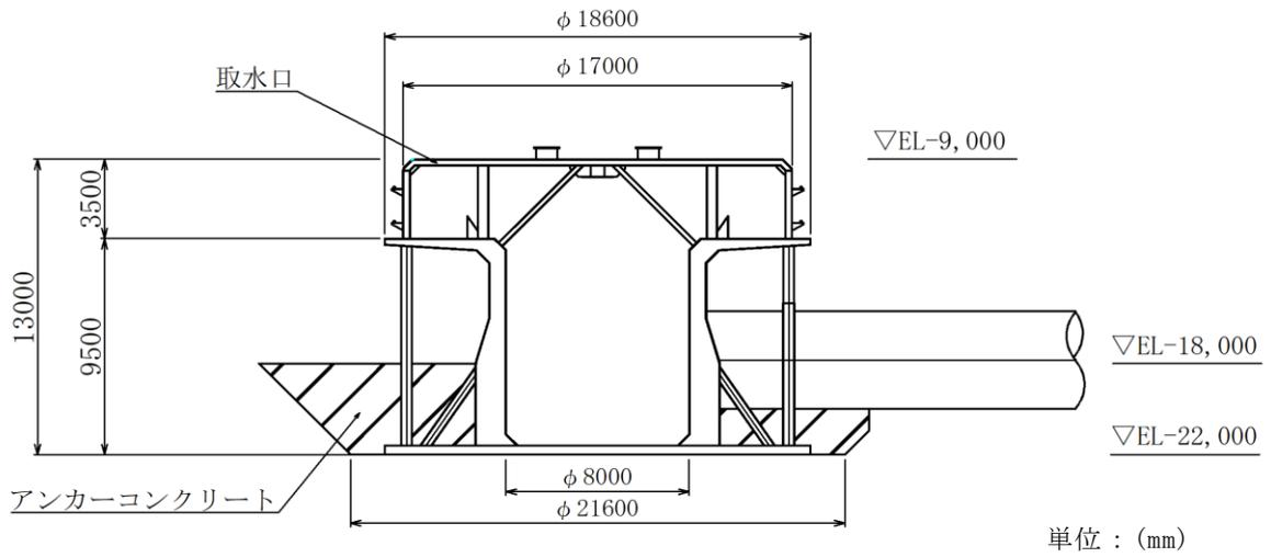
図 2-4 取水口 断面図 (A-A 断面)
