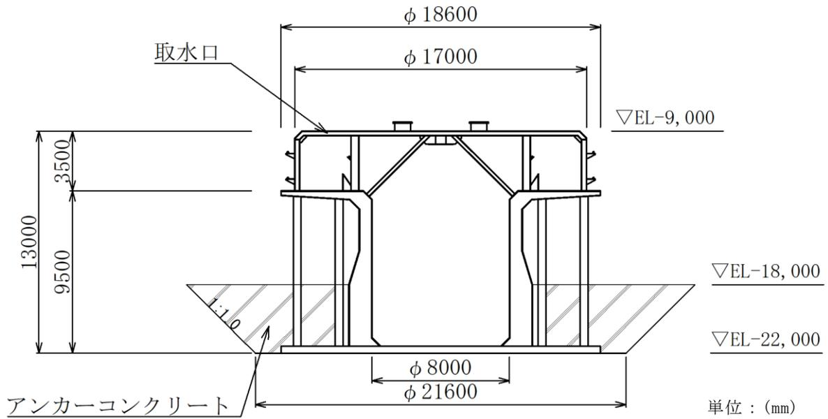
図 2-5 取水口 断面図 (B-B 断面)
