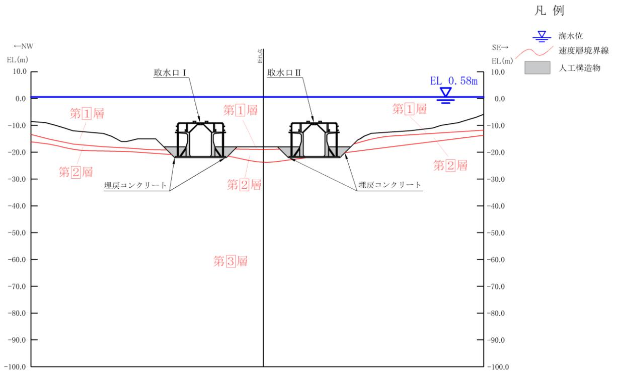
図 2-7 (2) 取水口 地質断面図 (B-B断面及びC-C断面)
