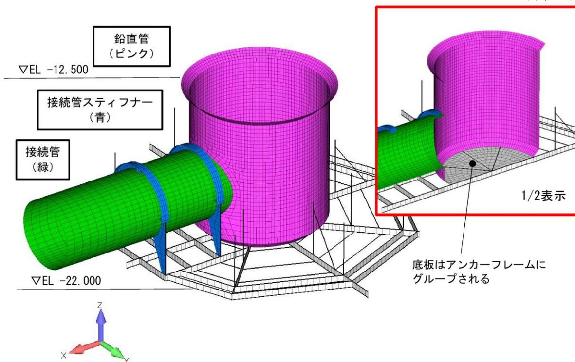
図 4-6 鉛直管及び接続管部応力照査箇所
