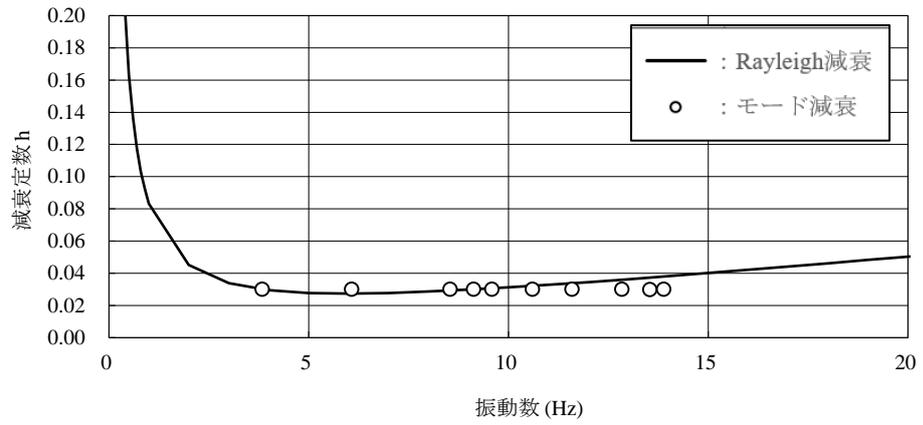
図 3-17 設定した Rayleigh 減衰 (D-D 断面)
