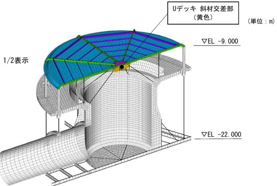
図 2-12 Uデッキ部応力照査箇所
