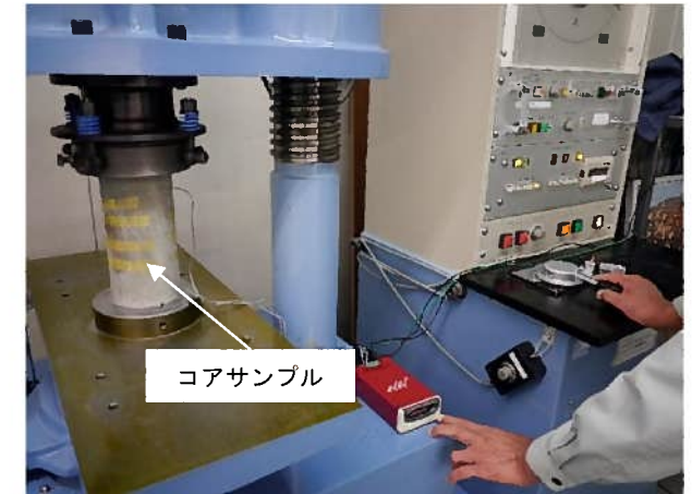
強度の点検状況
