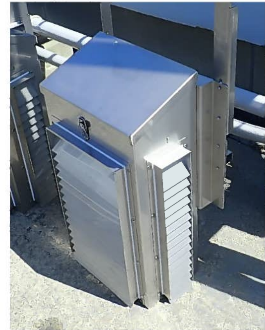
飛来塩分捕集器（ドライゲーゼ法）
