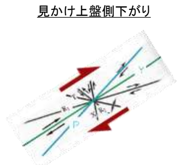
せん断センスを示す複合面構造 (狩野・村田(1998)に加筆)
