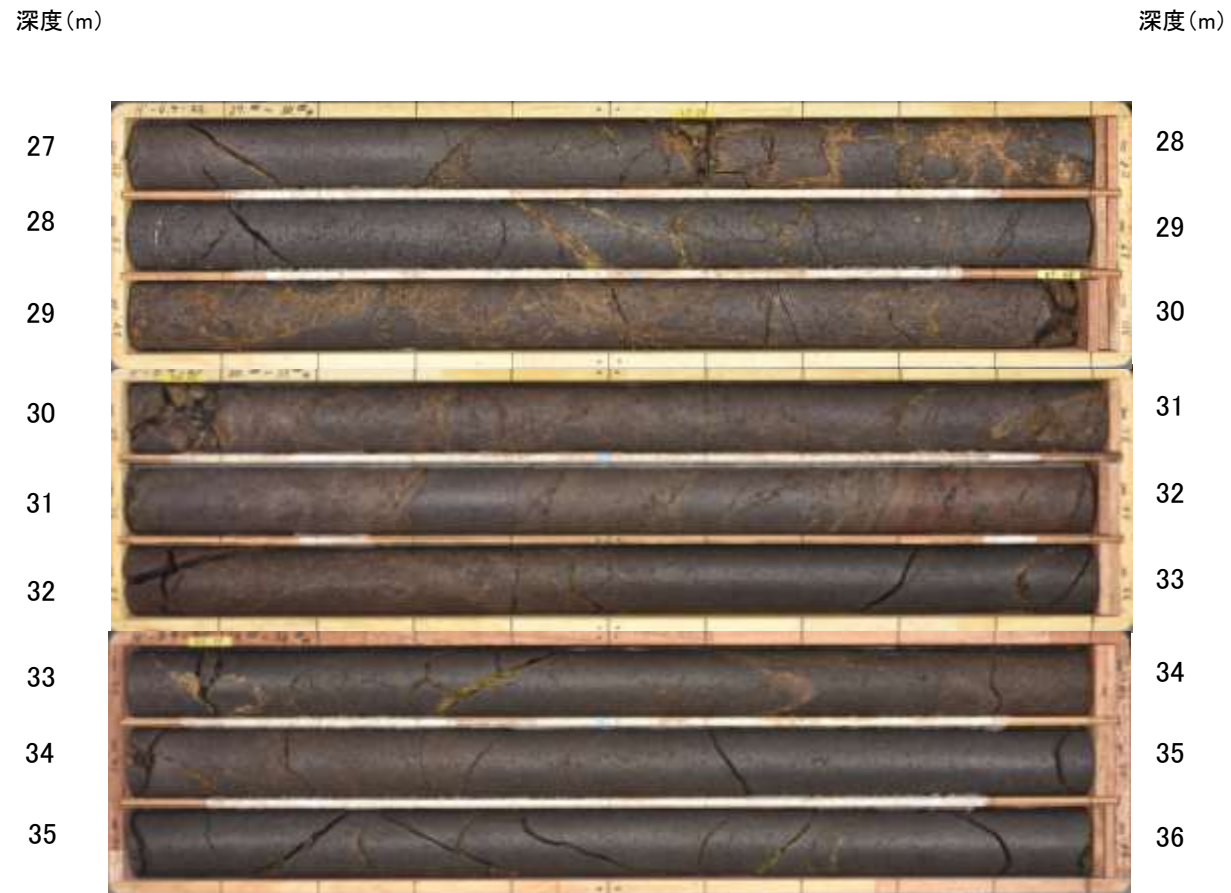
H' -0.9-45孔(掘進長40.00m, 傾斜45° )
