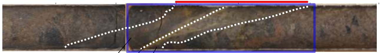
コア写真(H- -2.6孔, 破砕部区分を加筆)
