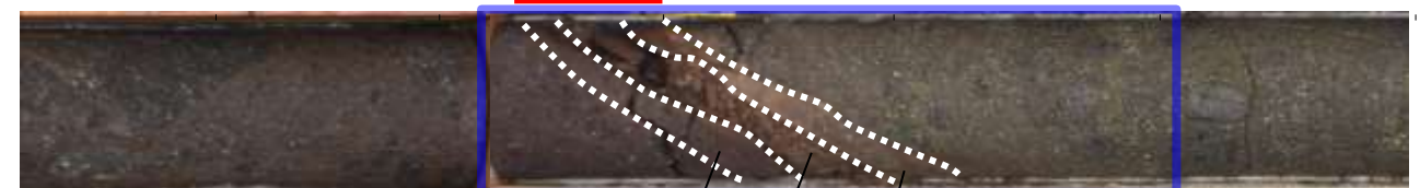
コア写真(H- -1.0孔, 破砕部区分を加筆)
