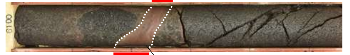
N27° E/54° NW ③-1 固結した粘土・砂状破砕部 D-10.2-1SE孔(下は破砕部を加筆)
