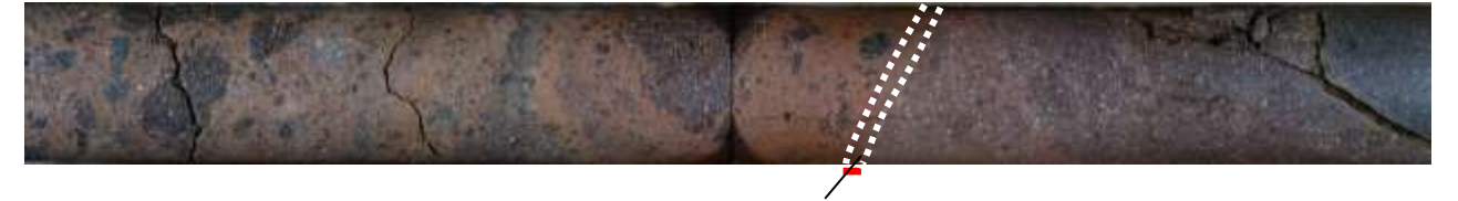
N27° E/53° NW ③-1 固結した粘土・砂状破砕部 E-10.8SE孔(下は破砕部を加筆)
