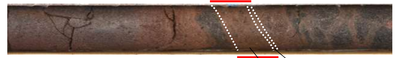
固結した角礫状破砕部 ③-2 ③-1 固結した粘土・砂状破砕部 N24° E/59° NW D-9.6SE孔(下は破砕部を加筆)
