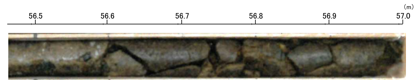
コア採取不良箇所
