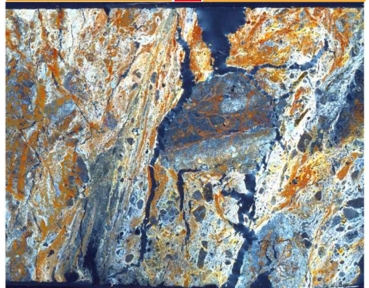
薄片写真(大坪川ダム右岸トレンチ_100R)
