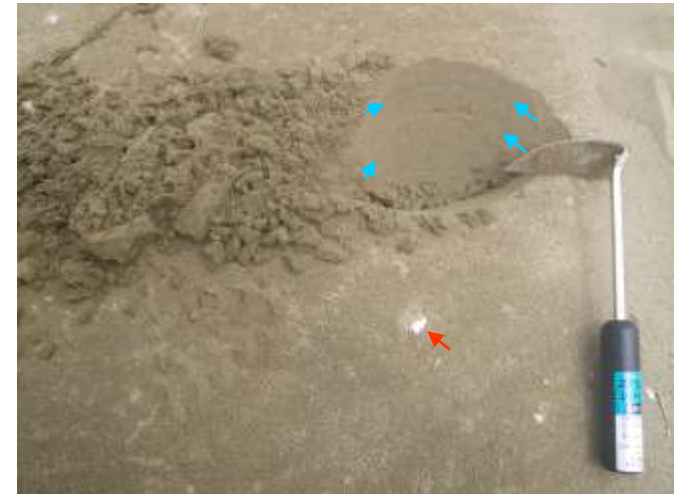
試料採取位置(近接) 層理 貝殻片 ・砂層中に弱い層理が認められる ・堆積物中に貝殻片を含む
