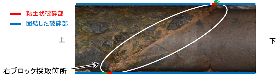
ボーリングコア写真(K-6.2-2孔)
