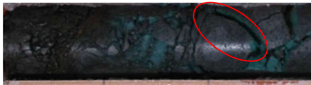
コア写真(F-1' 孔 36.0~36.3m) ○ 試料採取位置
